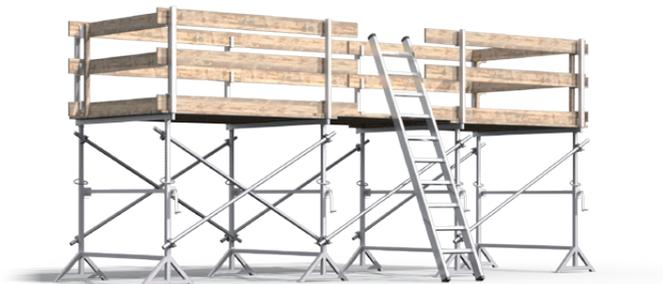
Ausziehbare Böcke sind nur in Metallausführung zulässig, für das Feststellen des ausziehbaren Teils ist ein ausreichend starker Steckbolzen zu verwenden, der mit dem Bock dauerhaft verbunden sein muss (keine Bewehrungsseisen o. Ä.).
