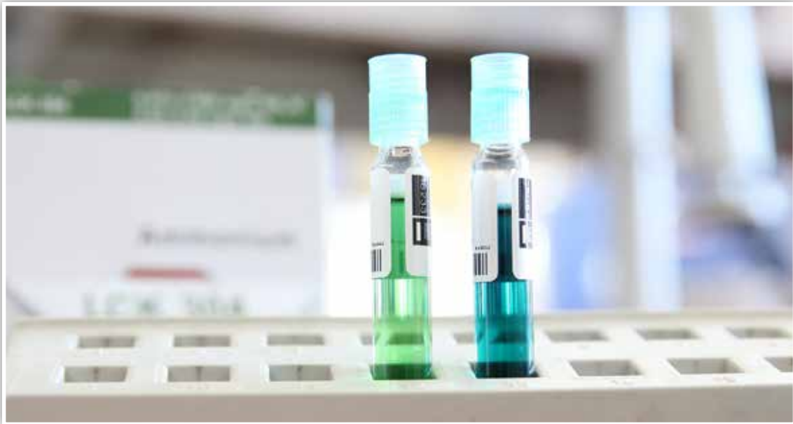
linke Küvette: Messbereich in Ordnung, rechte Küvette: Überschreitung des Messbereichs
