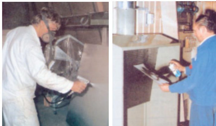
Solche Spritzarbeiten sind nur kurzzeitig und mit Atemschutz durchzuführen
