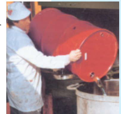
Hier fehlt die Erdung – Gefahr der statischen Aufladung
