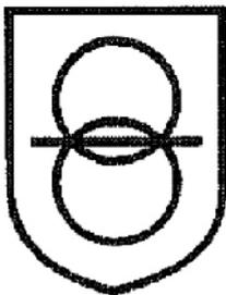
*Symbol zur Kennzeichnung von Transformatoren für Schutzkleinspannung*
