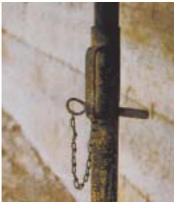
*Bei Stahlrohrstützen muss der Rundeisenstahldorn unverlierbar an der Stütze befestigt sein (z. B. mit Kette) oder eine unverlierbare Patentfixierung verwendet werden*
